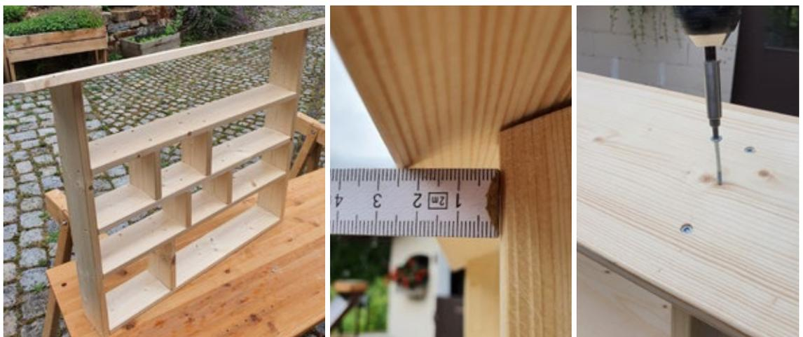
Das Dachbrett mit circa 25 mm Überstand auf den Korpus aufsetzen und mit 3 Schrauben pro Seite festschrauben.
