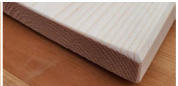
Mit Schleifpapier alle scharfen Kanten von Splintern befreien.
