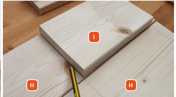
An den Seitenteilen mit einem Bleistift die Stärke der Böden einzeichnen (Teilschritt **1** **3** **5** **7**).
