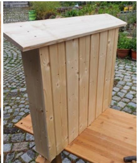
Die Mitte der Böden mit einem Bleistift anzeichnen. An mindestens 3 Böden die Rückwand pro Rückwandbrett mit 1 Schraube verschrauben.
